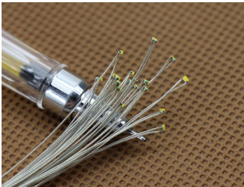
Kuva 29 Valmiiksi johdotettuja erittäin pienikokoisia pintaliitostyyppisiä LED-valoja.
